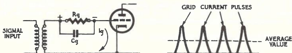
FIG. 13. GRID LEAK BIAS.
