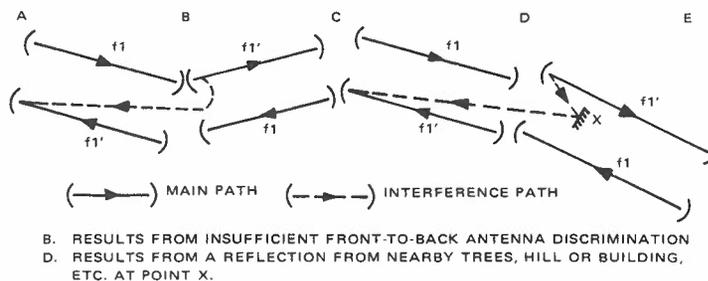
B. RESULTS FROM INSUFFICIENT FRONT-TO-BACK ANTENNA DISCRIMINATION
