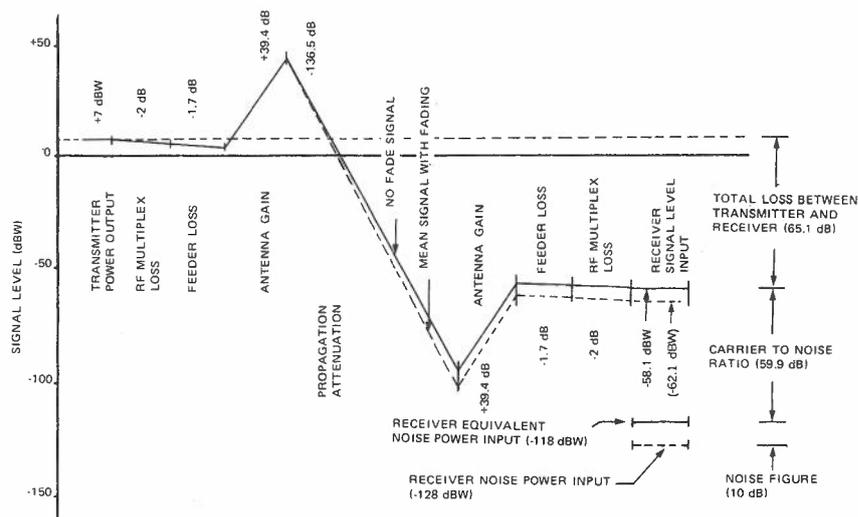
FIG. 12. TYPICAL BEARER SYSTEM CARRIER AND NOISE LEVELS
