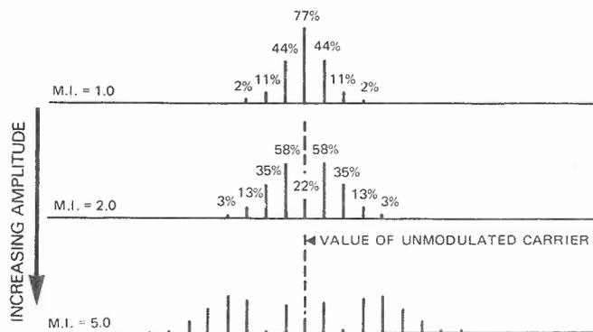
FIG. 2. FREQUENCY MODULATION SIDEBANDS-
