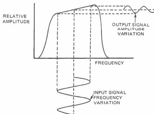
FIG. 17. DEGRADED AMPLITUDE-FREQUENCY CHARACTERISTIC
