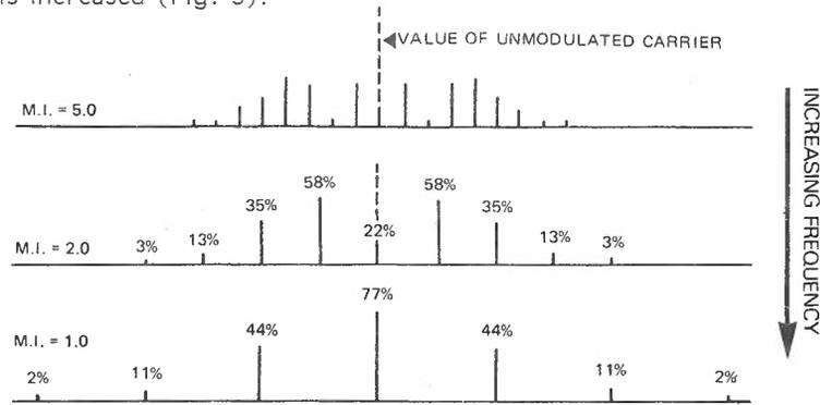
FIG. 3. FREQUENCY MODULATION SIDEBANDS- EFFECTS OF INCREASING MODULATING FREQUENCY
