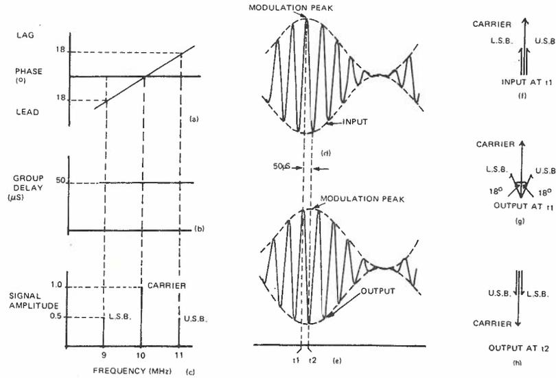
FIG. 9. EFFECT OF CONSTANT GROUP DELAY - FREQUENCY CHARACTERISTIC
