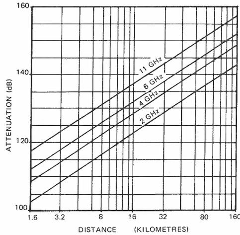
FIG. 10. FREE-SPACE ATTENUATION BETWEEN ISOTROPIC ANTENNAE.
