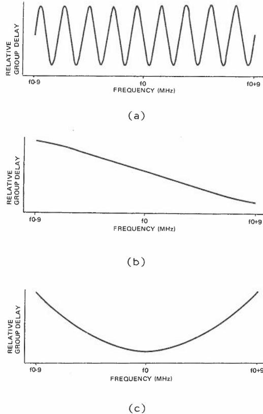
FIG. 20. TYPICAL GROUP DELAY - FREQUENCY CHARACTERISTICS
