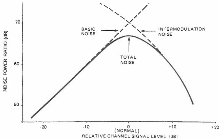
FIG. 29. EFFECT OF CHANNEL SIGNAL LEVEL ON NOISE
