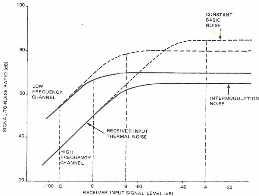
FIG. 30. SIGNAL TO NOISE - RECEIVER SIGNAL LEVEL CHARACTERISTIC
